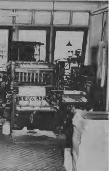
E LUGAR nobu undu Aruba Easo News ta worde impena ta Aruba Drukkerij N.V. na Oranjestad. Aki Gerhard H. Ruepert ta opera e prensa ariba cual e corant a worde impresu. Na banda robes tin un mašin cual por dabra benter e 9000 copianan impresu den un ora.
